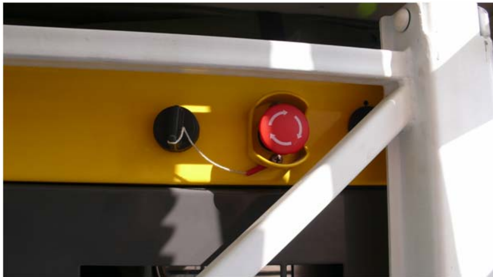
รูปที่ 1 ภาพด้านหน้าบริเวณกุญแจสตาร์ทสีดำ และปุ่ม Emergency stop สีแดง
