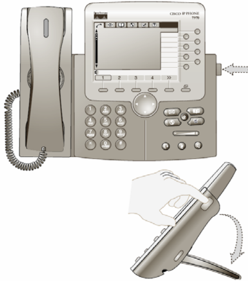
รูปที่ 19 การปรับขาตั้งของ IP Phone 7970
